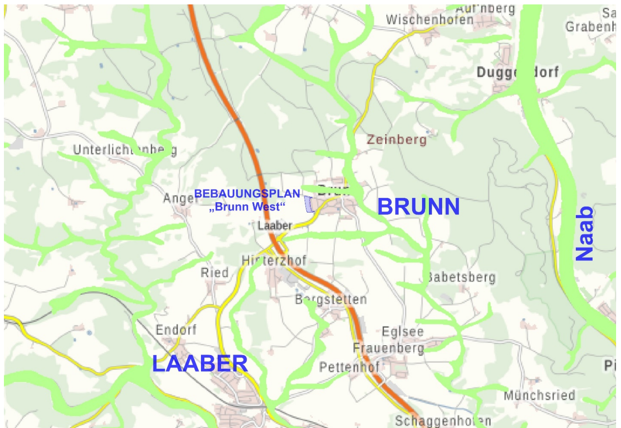
Karte 9: Auszug aus Bayernatlas mit Darstellung des wassersensiblen Bereichs (grüne Flächen). Verkleinerte Darstellung ohne Maßstab, Bearbeitung: Ing.-Büro Wöhrmann
